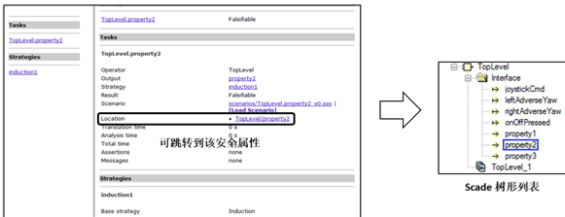
SCADE 形式化分析错误后导入反例进行白盒仿真
